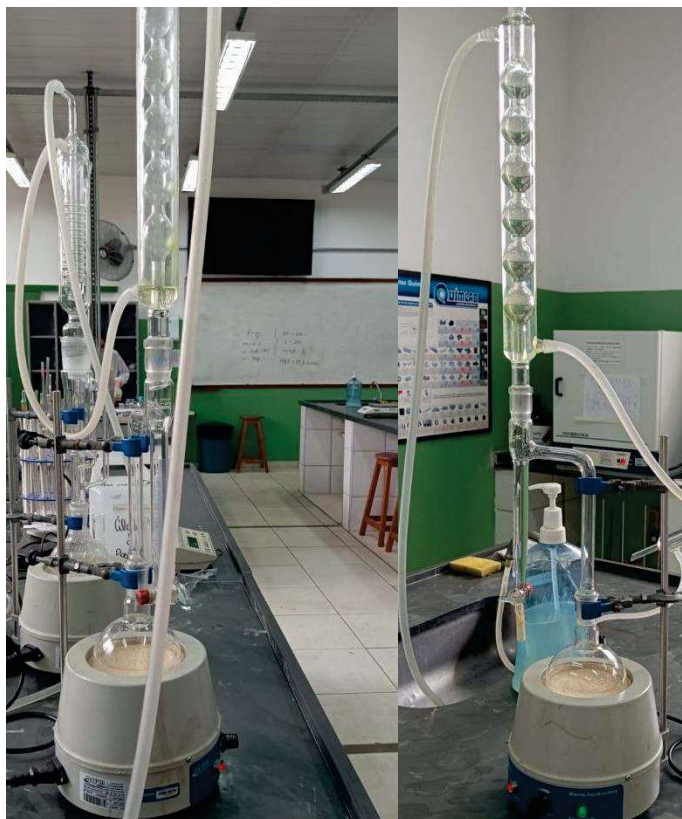
Figuras 12 e 13: equipamento do método por Dean-Stark.
