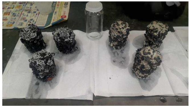
Imagem 18: Concreto após o ataque químico
