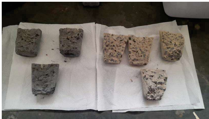
Imagem 24: Concretos após a ruptura vertical
