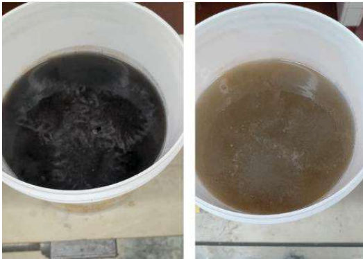
Imagem 17: Baldes após submergir o concreto
