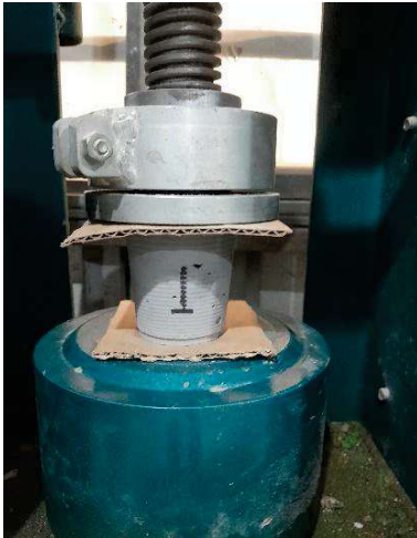
Imagem 21: Concreto na prensa
