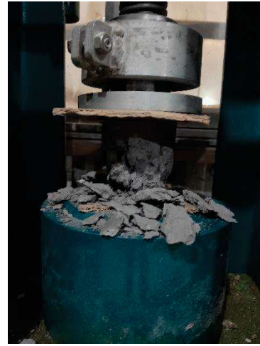
Imagem 22: Concreto após a ruptura
