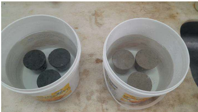
Imagem 20: Concreto Submerso na Água
