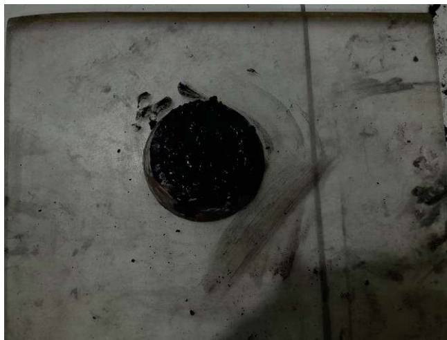
Imagem 6: Slump Test do Concreto com CBC
