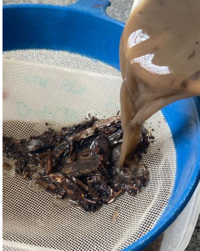
Figura 36: Peneiração da amostra do solo
