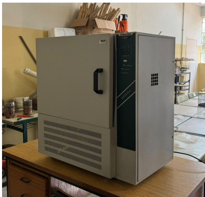
Figura 2 Estufa de circulação fechada em que foi realizada a etapa de secagem das plantas à 65°C por 48 horas
