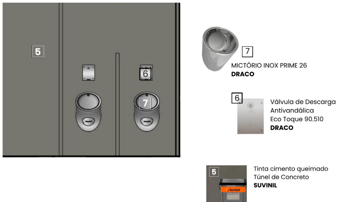
Figura 67 - Vista AA com acabamento: banheiro masculino
