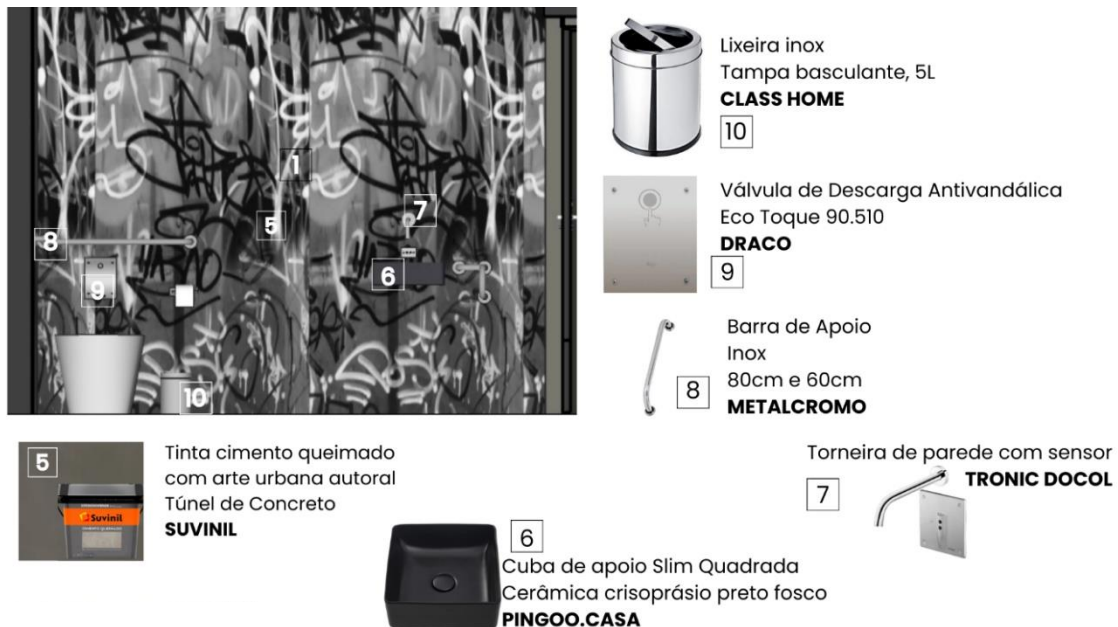
Figura 42 - Vista AA com acabamento: banheiro PNE
