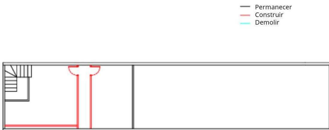
Imagem 17 – Planta de reforma terceiro pavimento
