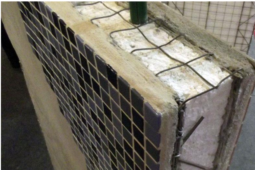
Figura 14: O acabamento do painel revestido
