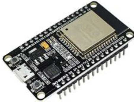
Figura 03- Placa Esp32 Wifi / Bluetooth 30 Pinos
