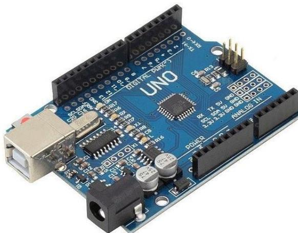
Figura 5: Placa Arduino UNO R3, FONTE: Eletrogate.
