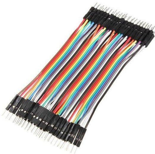
Figura 8: Jumper Macho-Macho, FONTE: Eletrogate.
