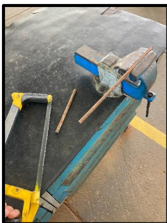
Figura 9 - Serragem e torneamento da barra
