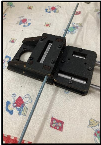
Figura 11 - Barra roscada do eixo Z
