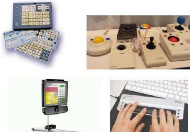
Teclado expandido e programável IntelliKeys, diferentes modelos de mouse e sistema EyeMax para controle do computador com movimento ocular, Linha Braille.
