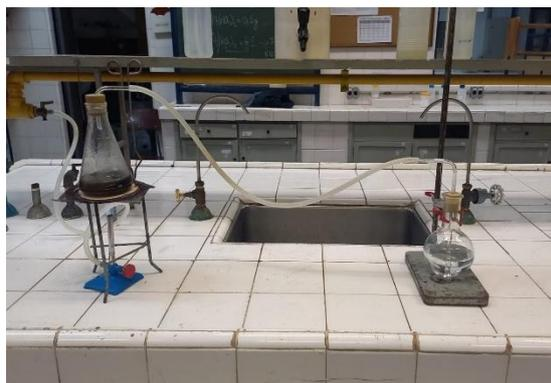
Figura 1. Sistema de extração do H<sub>2</sub>S – 1
