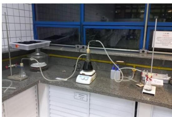
Figura 2. Sistema de extração do H<sub>2</sub>S - 2
