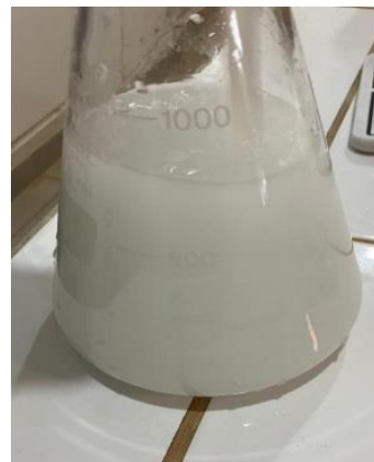
Figura 2. Pesagem e adição da soda cáustica na água destilada
