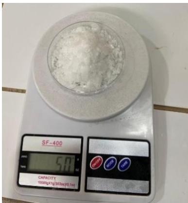
Figura 2. Pesagem e adição da soda cáustica na água destilada
