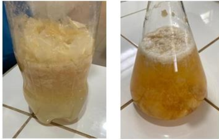
Figura 3. a) Colágeno com a soda cáustica na garrafa. b) Colágeno depois de 1 semana.
