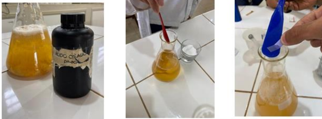
Figura 4. a) Ácido oxálico . b) Adição de ácido clorídrico . c) Medição de pH .
