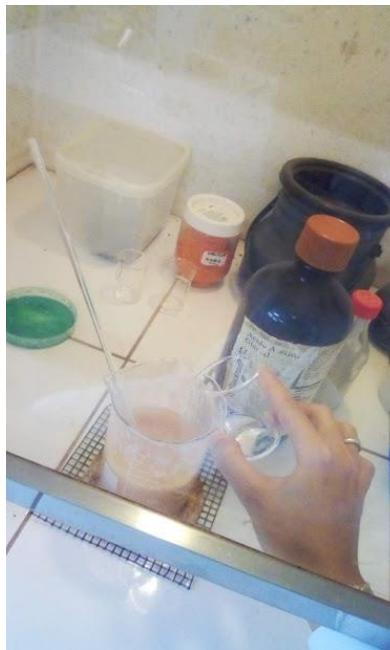
Figura 17: A mistura foi retirada da chapa com o auxílio de uma pinça metálica e colocada em uma tela de amianto para que fossem adicionados 4g de Glicerina e 6g Ácido acético dentro da capela.
