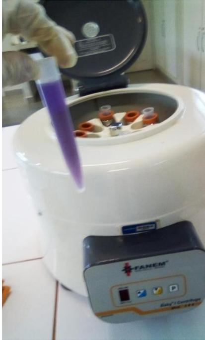
Figura 10: Logo após o líquido foi separado em 4 tubos de ensaio e foram distribuídos na centrífuga com 100 RPM por 5 minutos.
