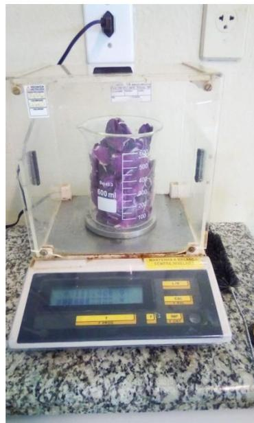
Figura 2: Pesar 100g do repolho em uma balança analítica
