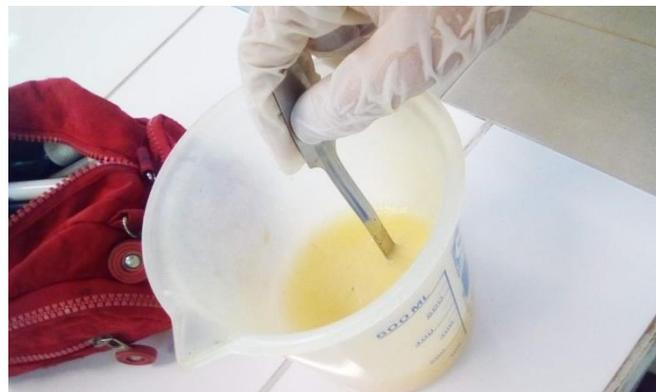
Figura 15: Preparação da solução aquosa de 200 ml de água destilada com 24 g do resíduo de milho em temperatura ambiente e 30g do resíduo do repolho separado no processo anterior.
