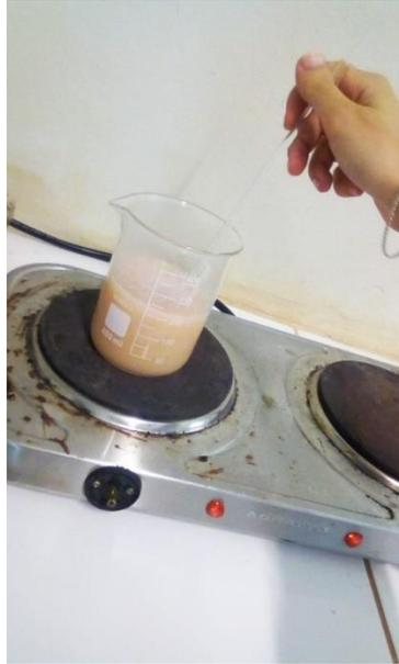
Figura 16: Colocou-se esta mistura a chapa de aquecimento a 200 °C por alguns minutos até que levantasse fervura, mexendo constantemente com o bastão de vidro para não queimar.
