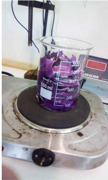
Figura 3: Adicionar 200ml de água destilada e submeter ao aquecimento por 20 minutos após levantar fervura
