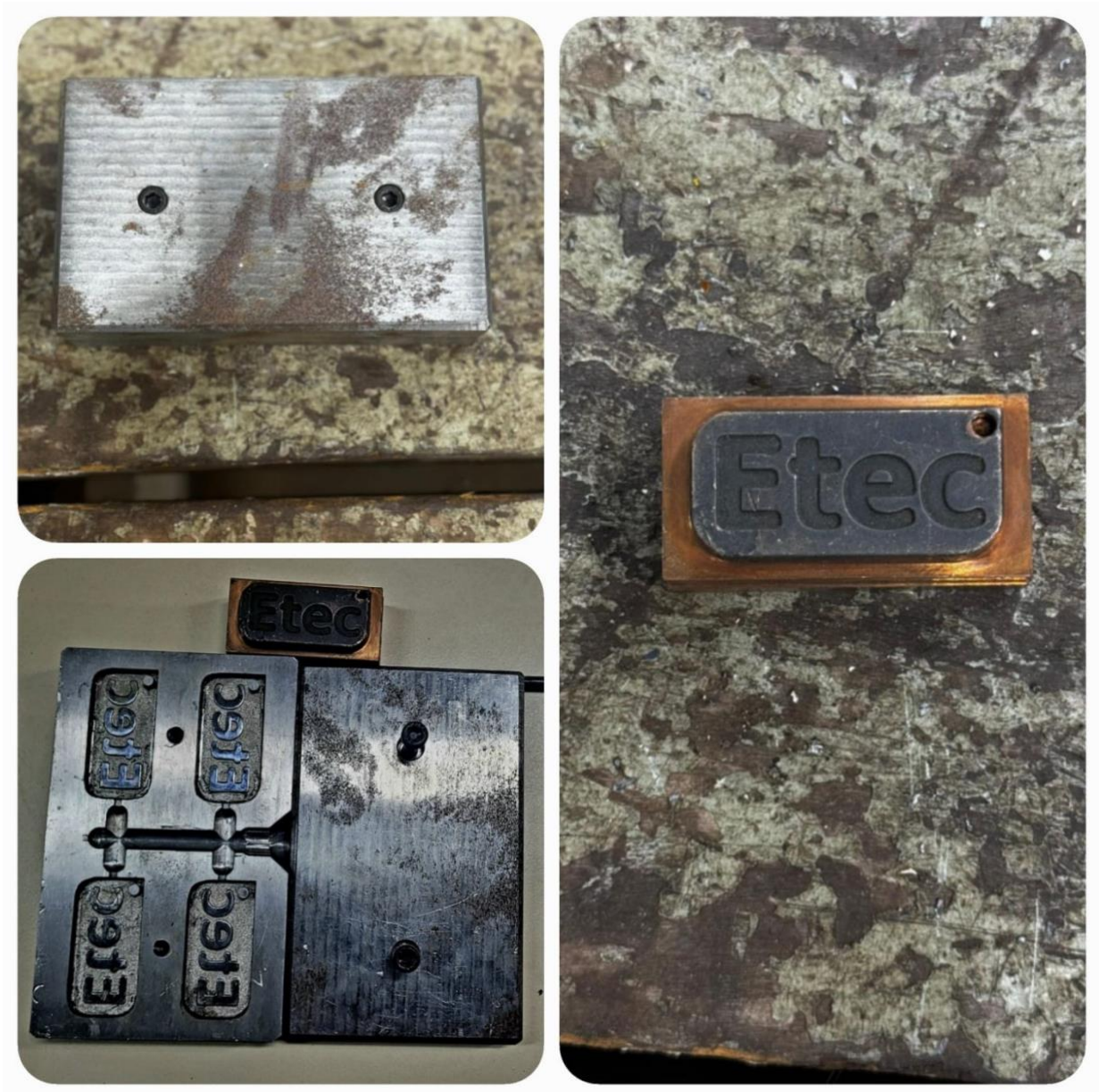
-MOLDE ETEC 4 CAVIDADES/ FERRAMENTA DE EROSÃO
