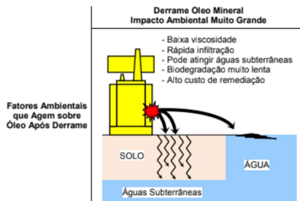
Figura 3 – Contaminação por vazamento equipamentos com isolamento a óleo
