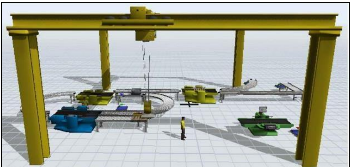
Figura 20 - Exemplo de layout 3D com ponte rolante e esteiras transportadoras
