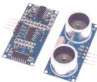
[ Figura 6 – Foto Sensor Ultrassônico HC-04. Fonte: Mercado Livre]
