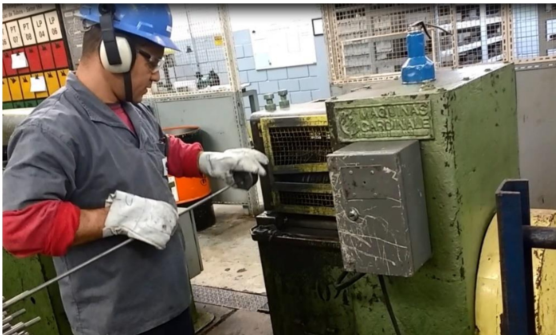
Figura 11 - Operador efetuando o teste com o padrão no processo de laminação.
