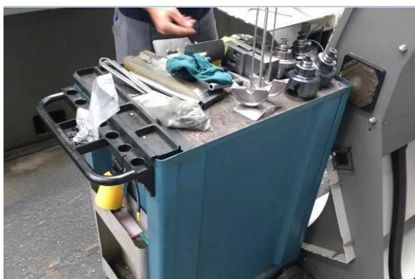
Figura 19 - Antes - Distribuição dos Cabeçotes sobre o carrinho com as pastilhas para baixo.
