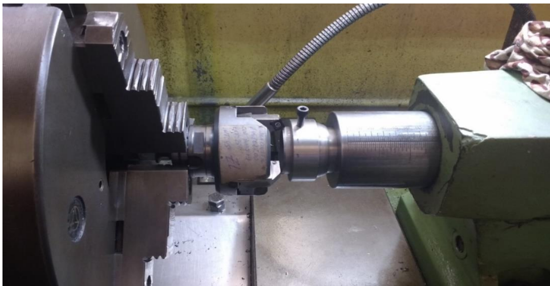
Figura 13 - Sugestão para o Setup Externo do cabeçote (Tryout no torno universal).
