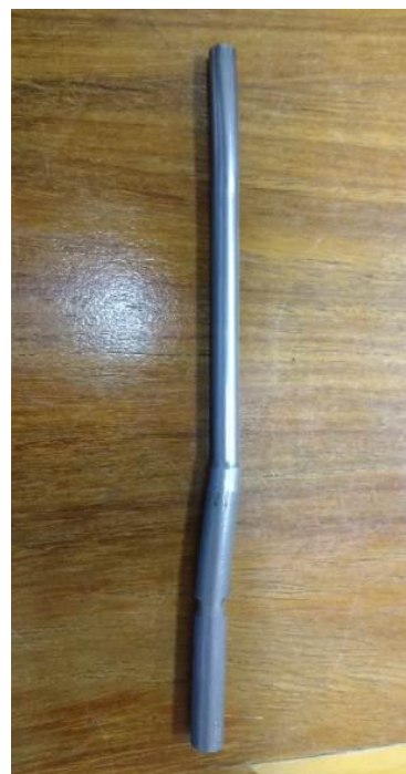
Figura 26 - Depois – Obtenção do tubo com a matriz com polimento e alteração do ângulo de entrada.
