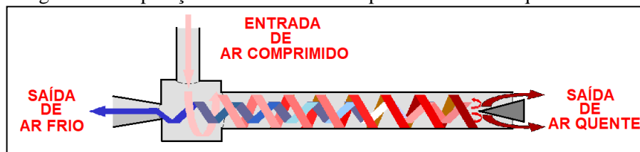
Figura 37 - Separação do fluxo de ar comprimido em fluxo quente e frio.
