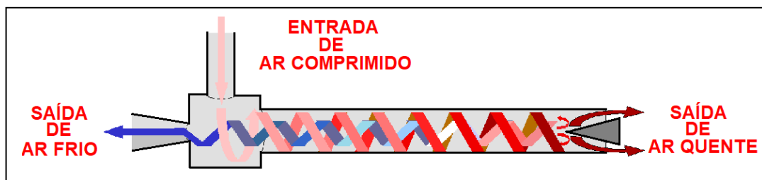
Figura 12 - Separação do fluxo de ar comprimido em fluxo quente e frio.
