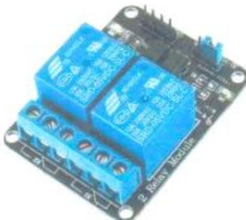
Figura 5: Módulo Relé de dois canais
