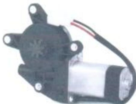
Figura 4: Motor de vidro elétrico
