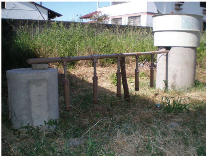
Figura 15. Amostrador que coleta água de chuva diretamente da atmosfera, segundo Hagemann (2009)
