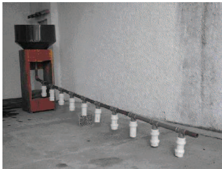
Figura 13. Dispositivo para coletar separadamente os 10 primeiros minutos da chuva, segundo Melo e Andrade Neto (2007)
