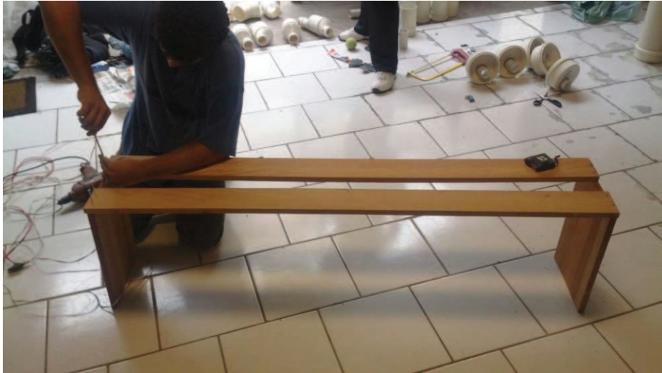
Figura 38. Montagem do banco suporte para os reservatórios do coletor de água de chuva
