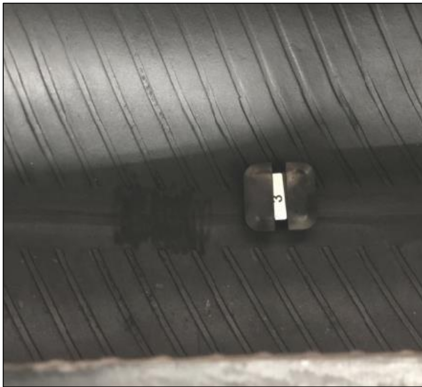
Figura 14 - Sensor TPMS instalado no pneu
