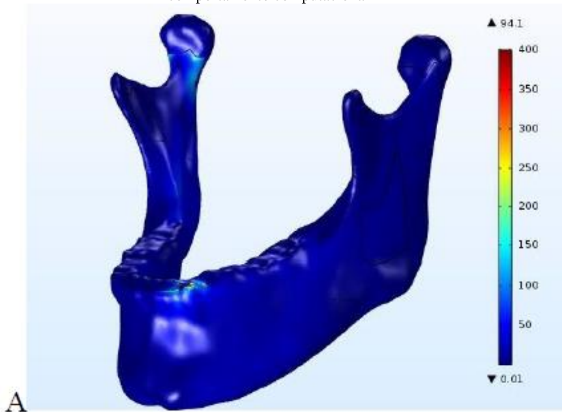
Figura 8 - Resultado de análise da distribuição de tensões aplicado ao modelo e seu comportamento computacional
