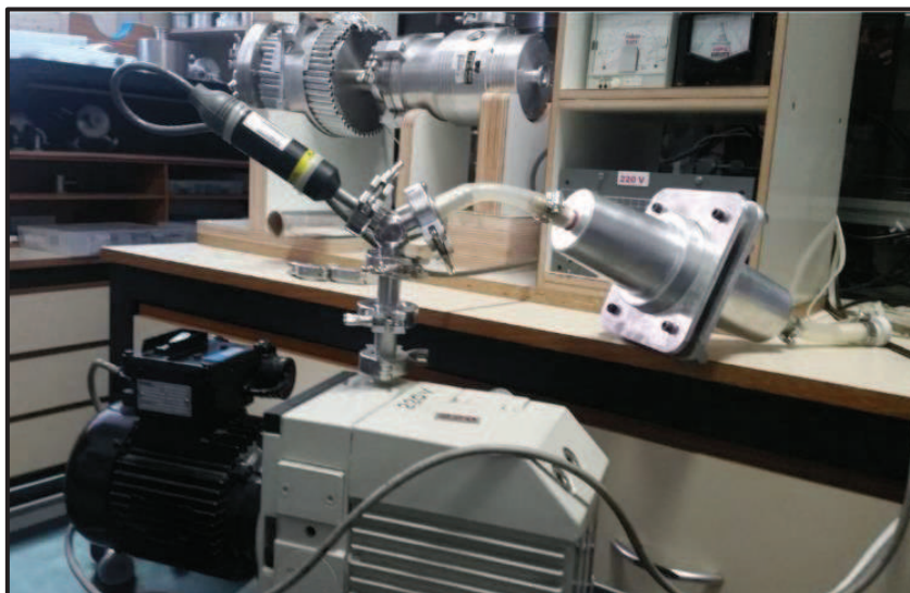
Figura 31: Fonte: Autor Visor do medidor de pressão Pirani
