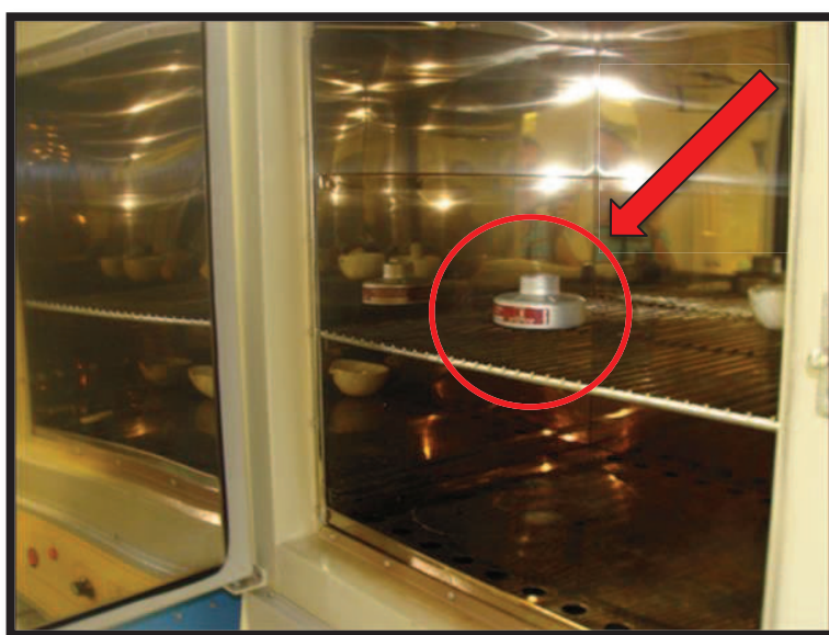
Figura 24: Ensaio de secagem do filtro químico, na estufa elétrica
