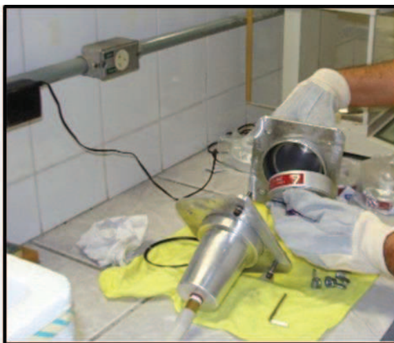
Figura 18: Filtro químico sendo inserido no dispositivo metálico (Câmara 2)
