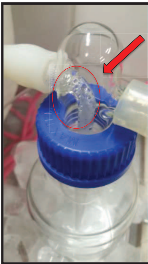
Figura 23: Formação de gotículas de condensados durante o ensaio de dessorção
