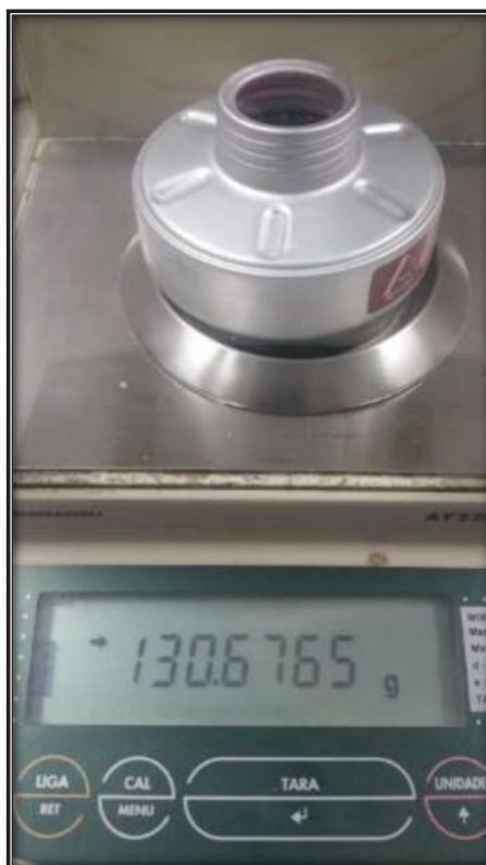
Figura 25: Pesagem do filtro químico preparado (FQP), após o ensaio de secagem
