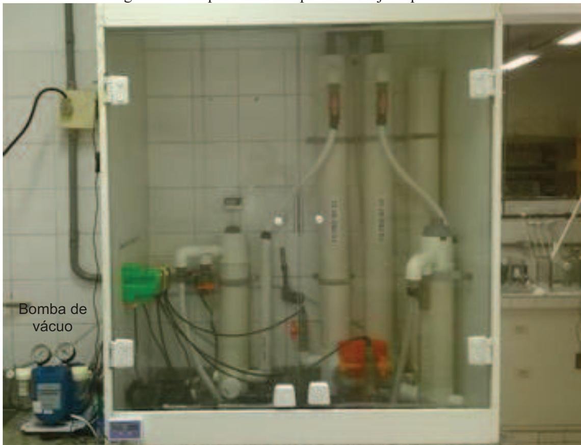
Figura 13 - Reservatório de amostras – 60 L
