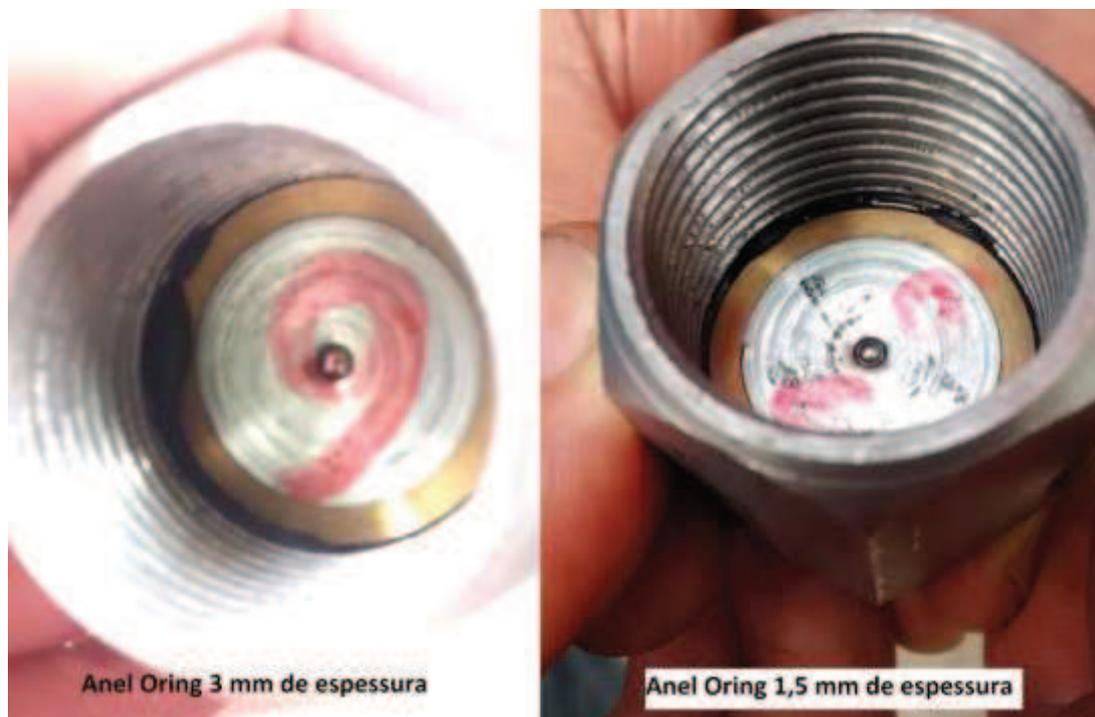
**Figura 42: Fotografia do adaptador com anel Oring fora do alojamento.**
