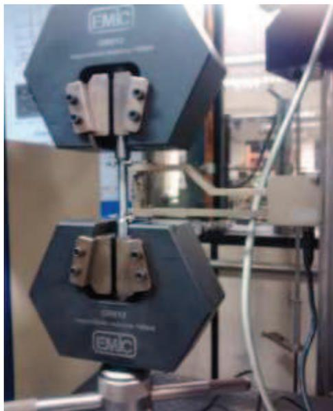
**Figura 20: Fotografia do extensômetro usado no primeiro ensaio.**
