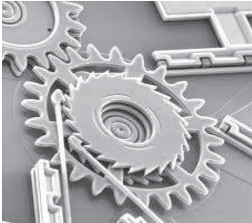
**Figura 1:** Imagem de engrenagens MEMS construídas utilizando as técnicas de fabricação da microeletrônica.
