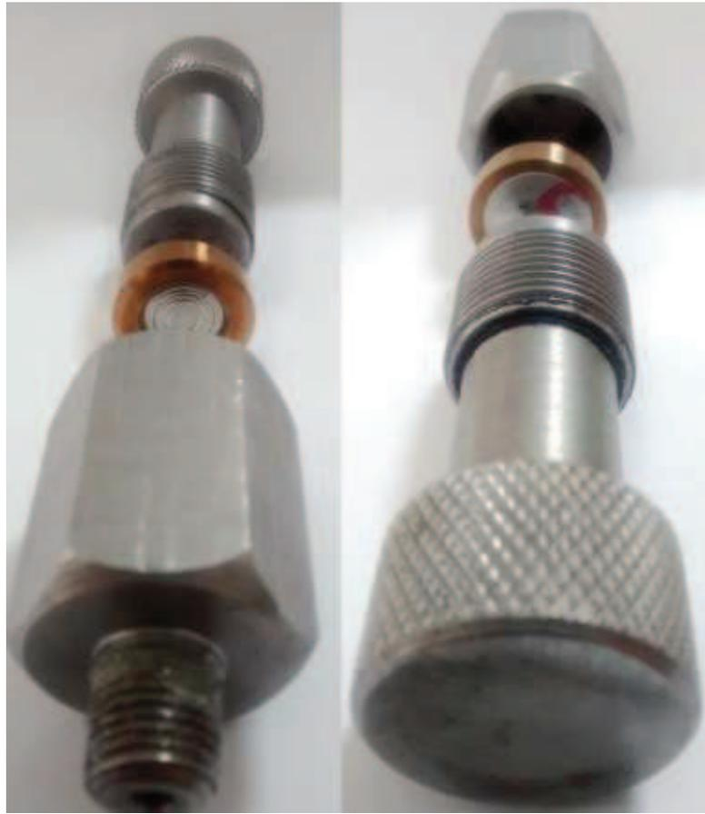
**Figura 36: Fotografias do adaptador para testes no Booster Hidropneumático.**
