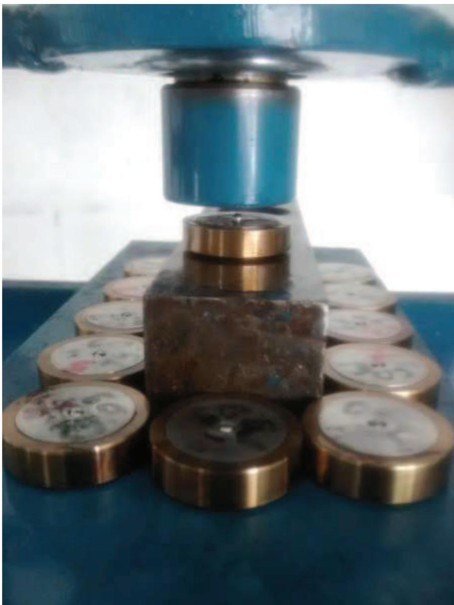
**Figura 33: Fotografia das cápsulas vedadas por uma esfera na Prensa (ORION).**
