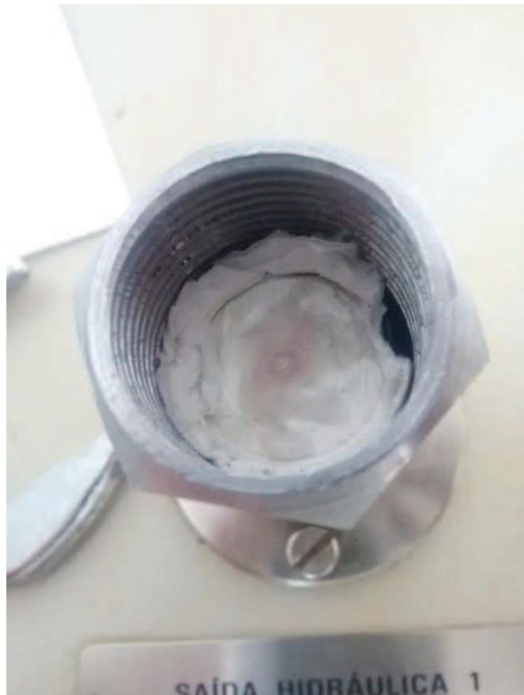
**Figura 41: Fotografia do adaptador com a cápsula N°6.**
