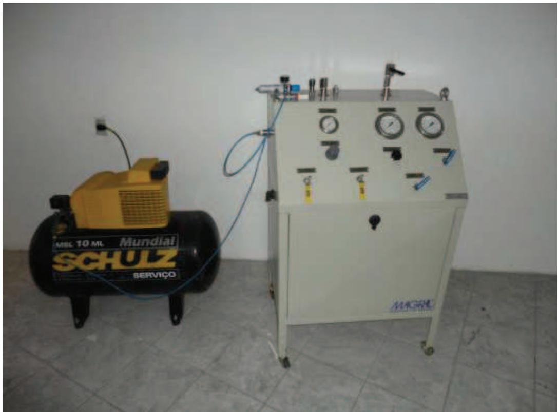
**Figura 35: Fotografia do Booster Hidropneumático (ORION)**
