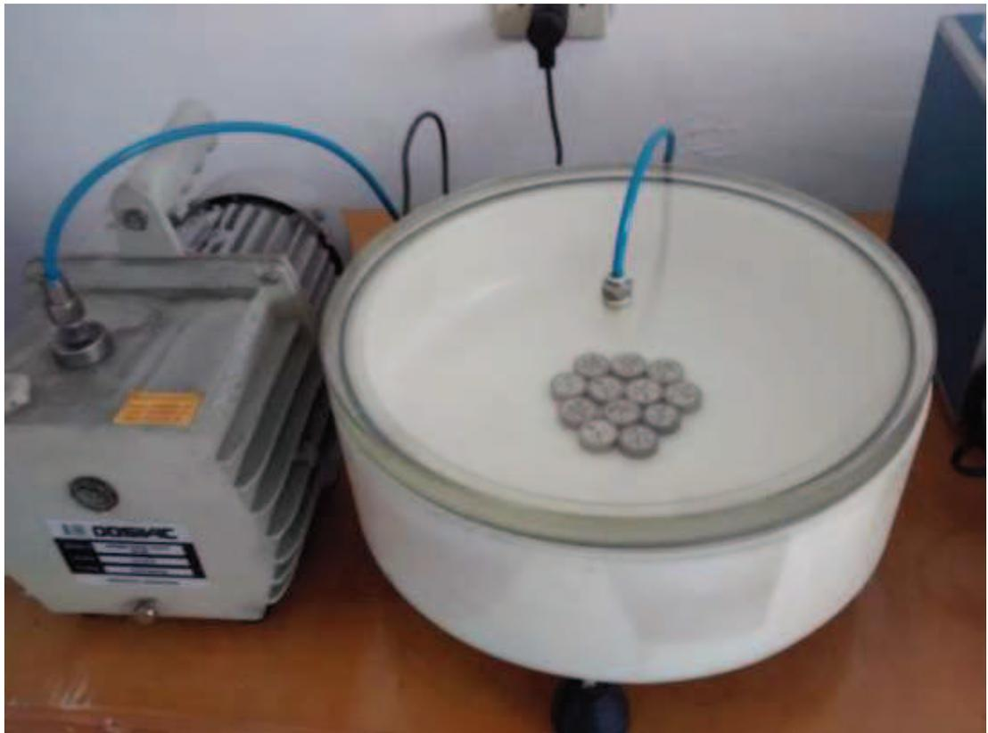
**Figura 31: Fotografia da Cuba e Cápsulas ao lado da Bomba de vácuo (ORION)**
