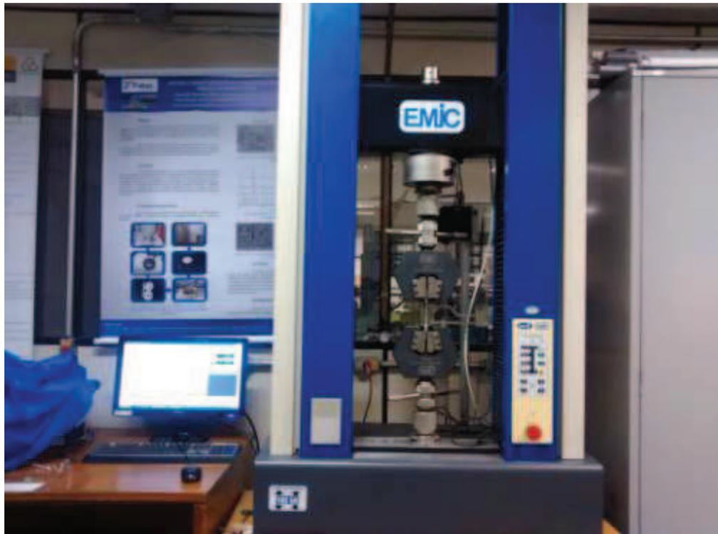
**Figura 19: Fotografia da Máquina Universal de Ensaios FATEC-SP.**
