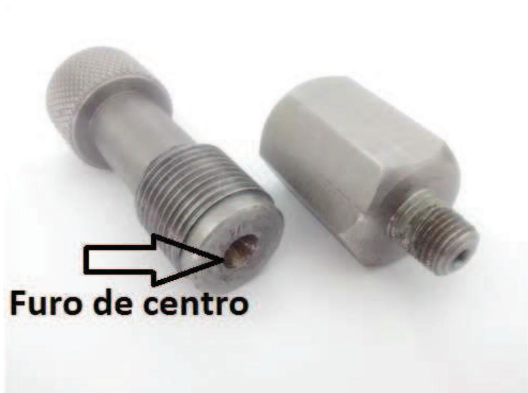
**Figura 40: Fotografia do adaptador com furo de centro.**
