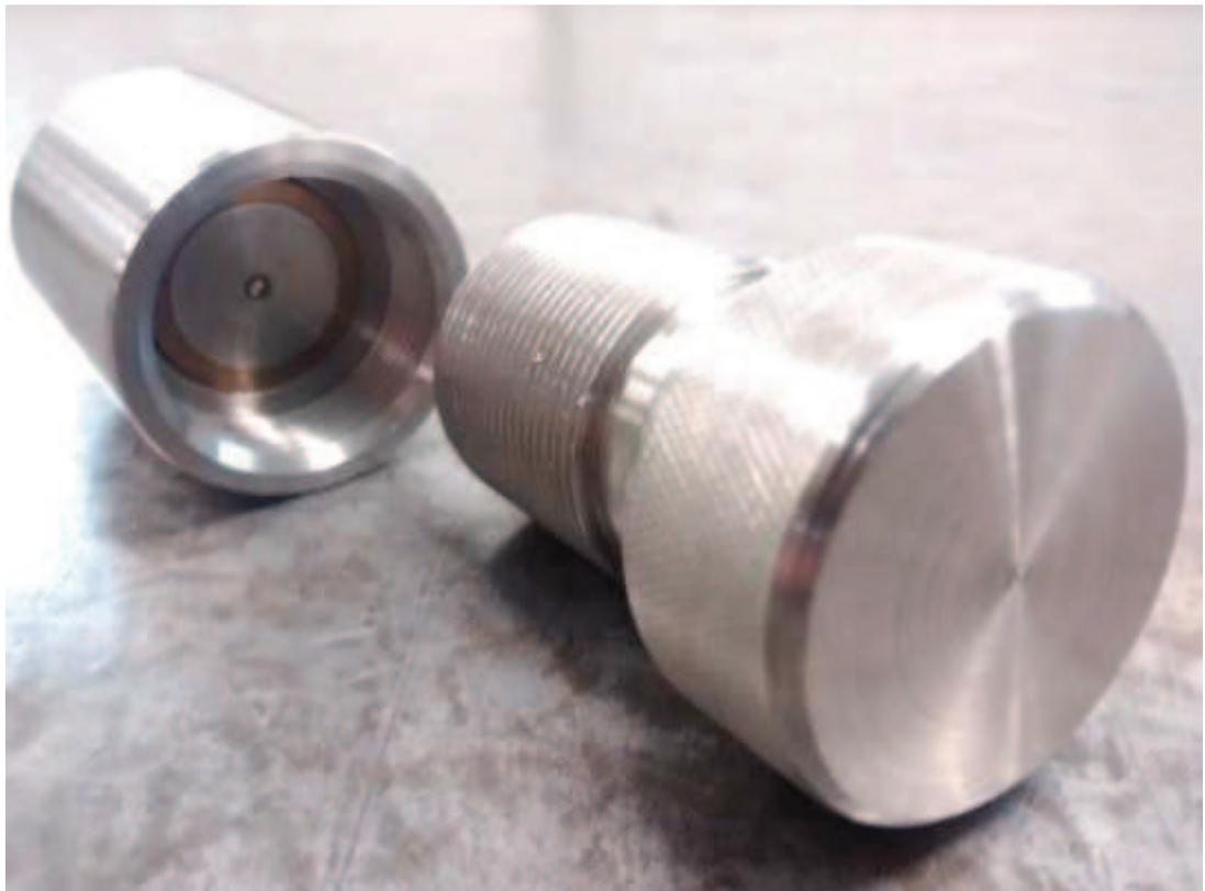
**Figura 37: Fotografia do novo adaptador para testes**
