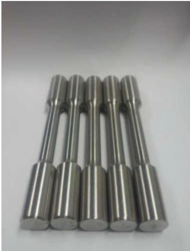
**Figura 18: Fotografia dos Corpos de Prova**
