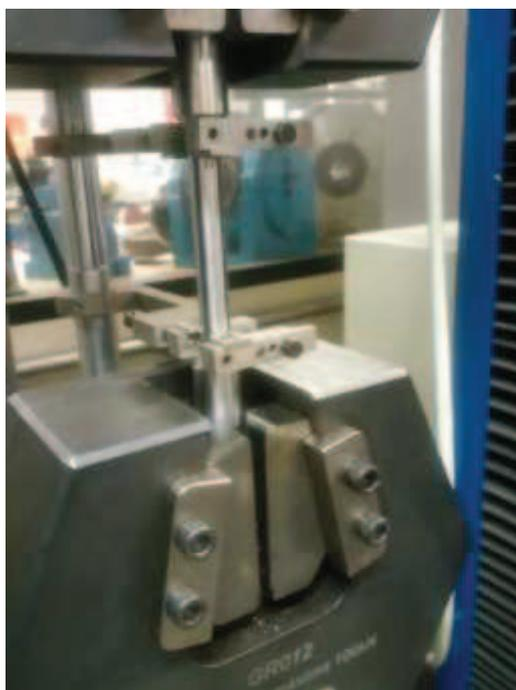
**Figura 21: Fotografia do extensômetro usado nos ensaios 2, 3, 4 e 5.**
