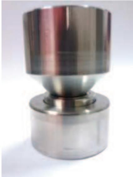
**Figura 27: Fotografia do gabarito de montagem das cápsulas.**
