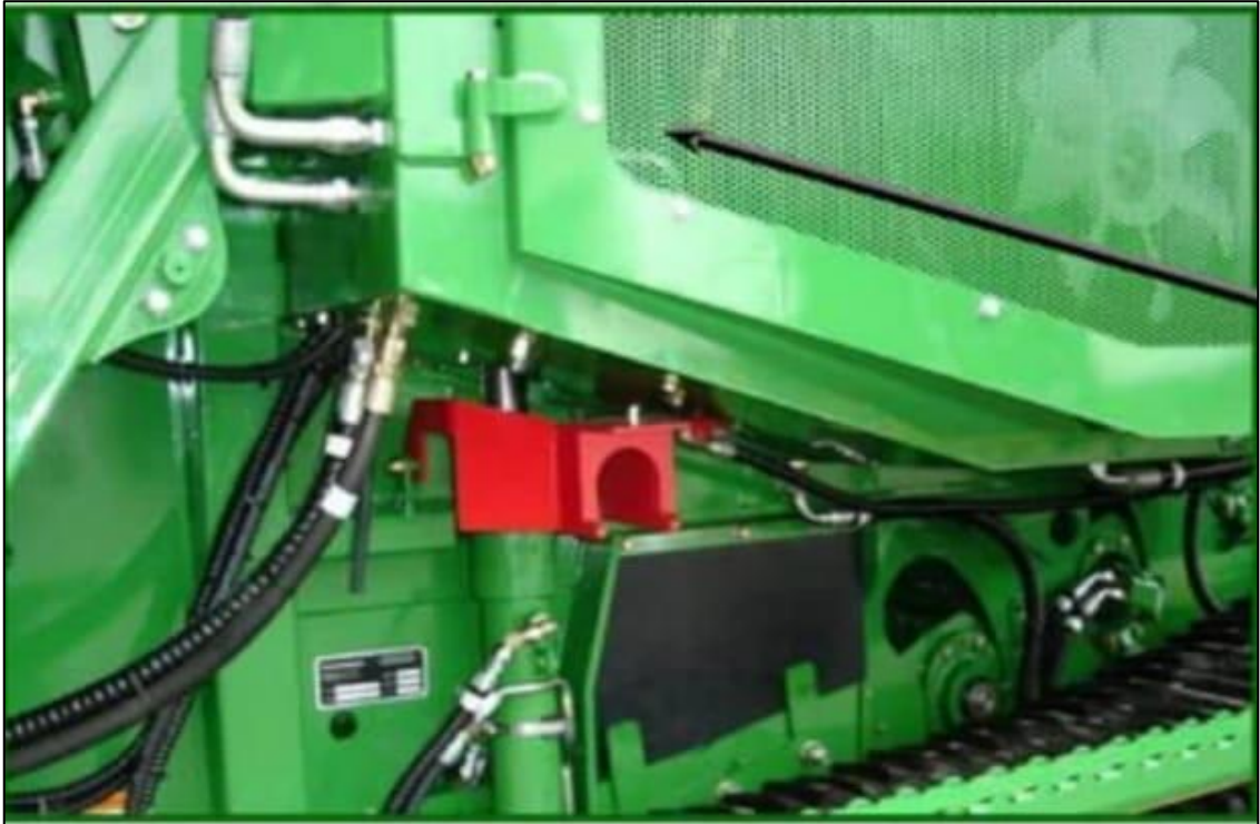
Figura 15: Trava de Segurança da suspensão da colhedora.
