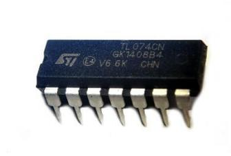
O circuito integrado TL074 consiste num amplificador operacional quadruplo com JFET na entrada, o que lhe dota de características de enorme resistência de entrada. Sendo assim, o amplificador operacional é um componente eletrônico capaz de amplificar sinais e realizar operações matemáticas, como por exemplo soma, subtração, multiplicação, derivação e integração.
