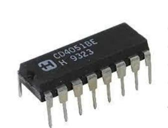
O circuito integrado CD4051 é um CI multiplexador e demultiplexador de 8 bits. Possui oito entradas ou saídas binárias ou saídas, três seletores de entradas, uma entrada de habilitação e uma saída ou entrada. Por possuir encapsulamento DIP, é o componente ideal para uso em placas de circuito impresso ou *protoboards*.
