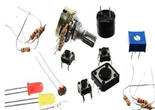
Led, Capacitor, Resistor, Diodo, Botão, Potenciômetro, Trafo.
