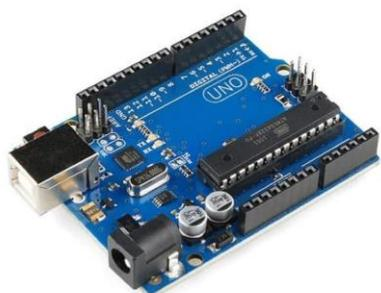
Arduino UNO é o micro controlador ATMEL ATMEGA328, um dispositivo de 8 bits da família AVR com arquitetura RISC avançada e com encapsulamento DIP28. Ele conta com 32 KB de *Flash* (mas 512 Bytes são utilizados para o *bootloader*), 2 KB de RAM e 1 KB de EEPROM.
