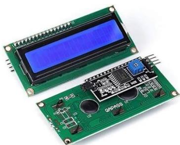
A série WO1602G é um módulo de visualização LCD com interface I2C COG (*Chip-on-Glass*) com conexão de pinos de metal, apresentando um formato de exibição de 16 caracteres x 2 linhas. Este módulo é equipado com um controlador IC ST7032i e suporta a interface I2C.
