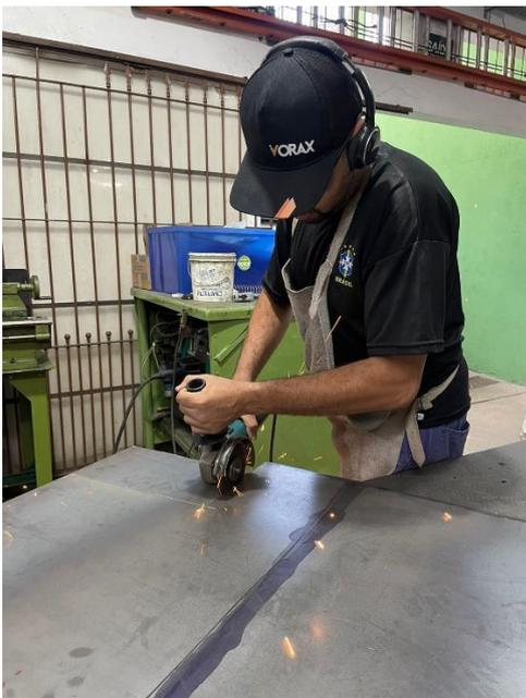
*Figura 4 – Processo de corte para teste e calibragem da solda.*
