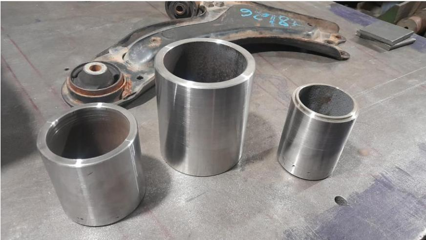
*Figura 14 – Tubos de berço, sacador e aplicador finalizados com acabamento.*
