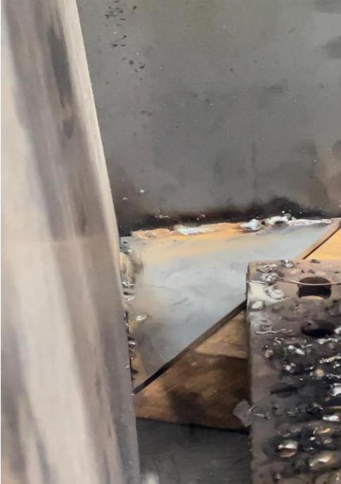
*Figura 7 – Solda interna na base do macaco.*
