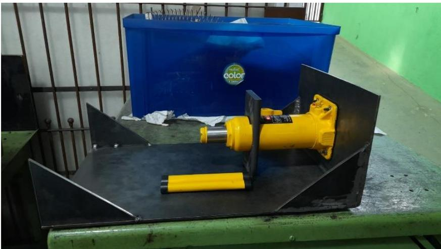
*Figura 8 – Macaco preso no apoio usinado.*
