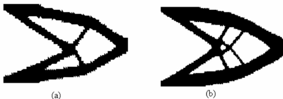
Figura 9. Dependência da malha no problema de OT com restrição de tensão Von Mises: (a) malha com 3840 elementos triangulares (b) malha com 19200 elementos triangulares.
