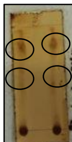
Figura 25- Cromatoplaça com revelador vapor de iodo
