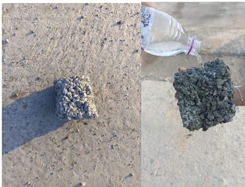
Figura 3 – Protótipo de Concreto permeável obtido na USP
