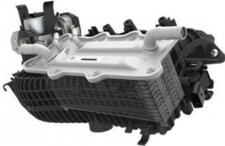
Figura 24 – Intercooler do tipo ar/água do veículo Up! TSI
