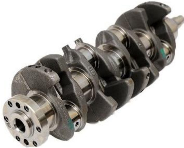
Figura 6 – Árvore de Manivelas
