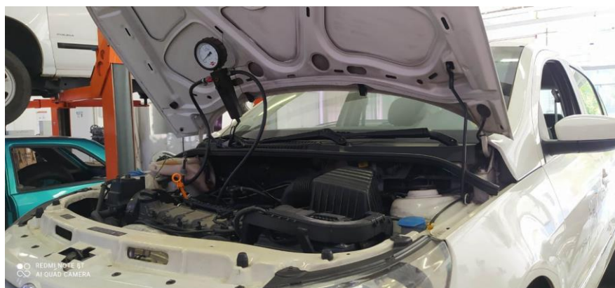
Figura 38 – Instrumentação Manômetro entrada de combustível
