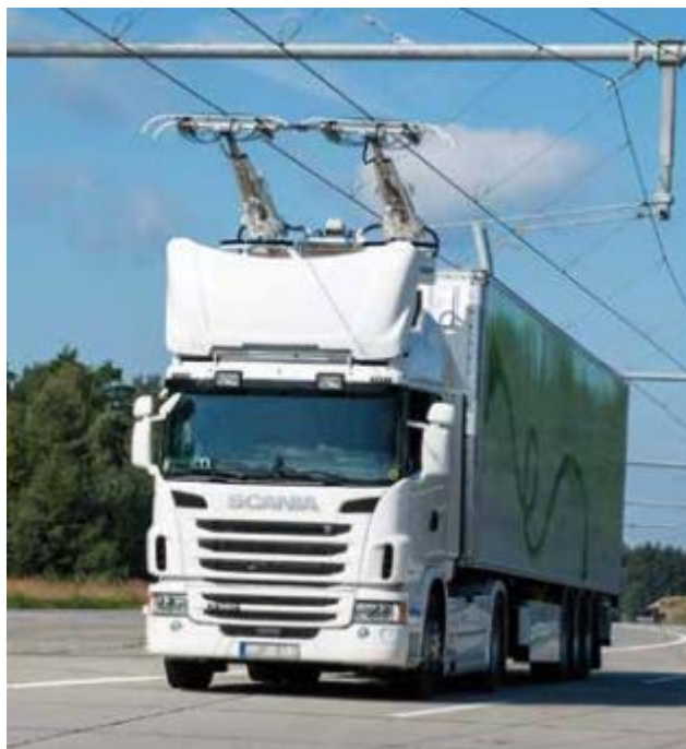
Figura 12 – Protótipo de E-Higway e veículo de teste.
