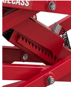
Figura 13 – Sistema de segurança efetuado por travas automáticas
