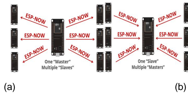
Figura 47 – a) configuração um mestre e múltiplos escravos. b) configuração um escravo e múltiplos mestres
