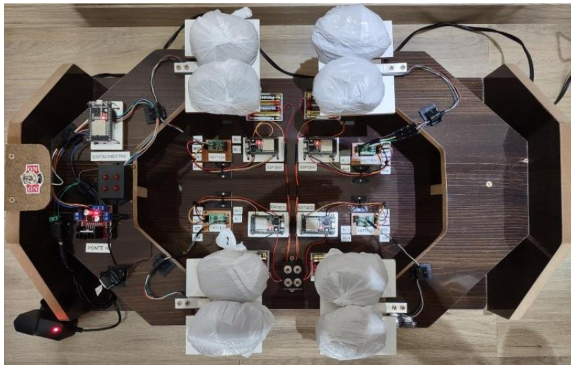
Figura 65 - Maquete com os pesos de 200 gramas aplicadas nas células de carga e o case de indicação com os LEDs desligado
