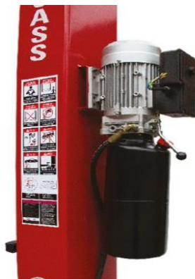
Figura 10 – Conjunto motor elétrico e bomba hidráulica.
