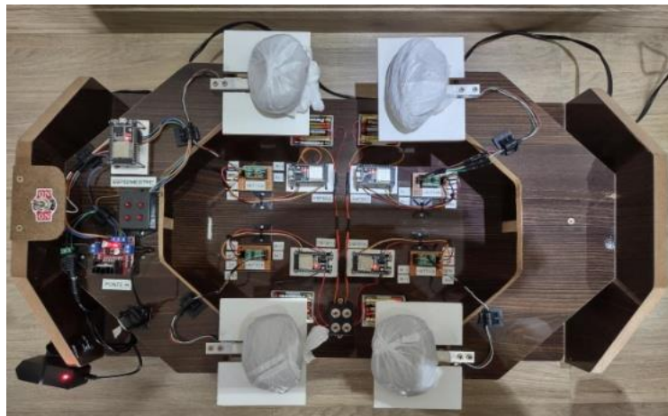
Figura 63 - Maquete com os pesos de 200 gramas aplicadas nas células de carga e o case de indicação com os LEDs desligado
