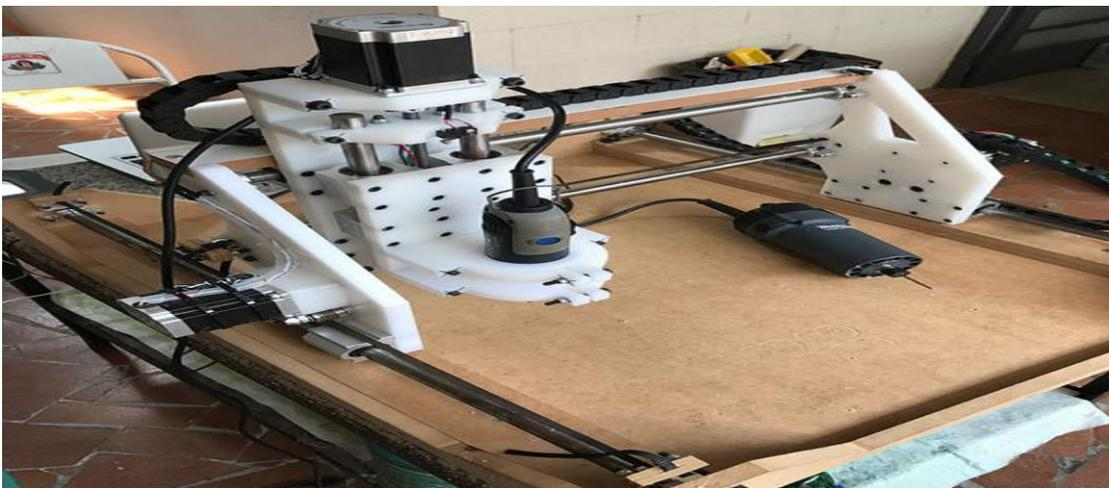
*Figura 1 – Fresadora CNC Atividade Maker*
