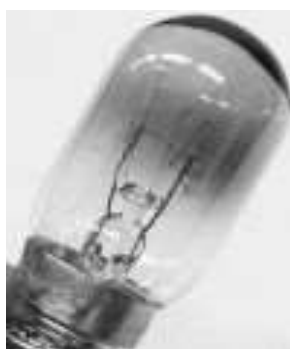
Figura 14: Lâmpada com evaporação dos átomos de tungstênio
