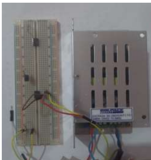
Figura 29: Circuito montado em protoboard e fonte de alimentação 12V
