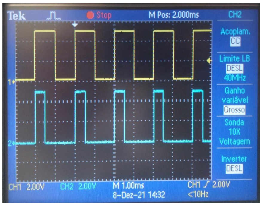
Figura 28. Pulsos enviados pelo PIC e pelo Arduino ao drive
