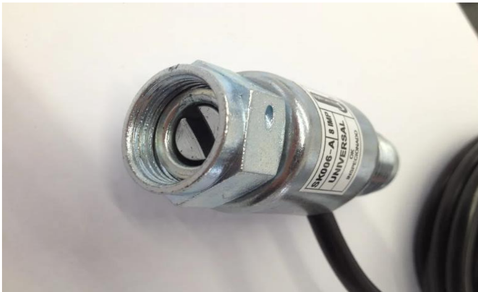
Figura 34 - Detalhe do Sensor para Tacógrafo Universal
