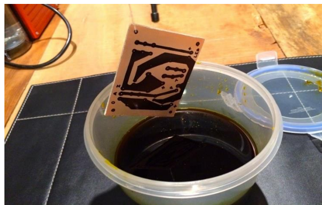
Figura 13 - Conclusão do Processo de corrosão da placa de circuito impresso
