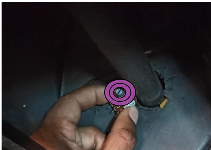
Figura 49 - Possível adaptação do Potenciômetro com a roldana
