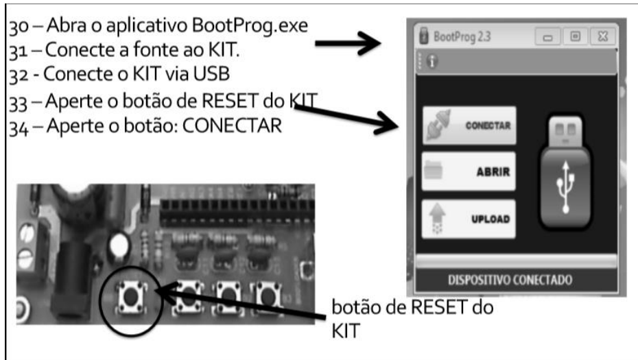
Anexo E - Figura 21 - Upload do software para a placa
