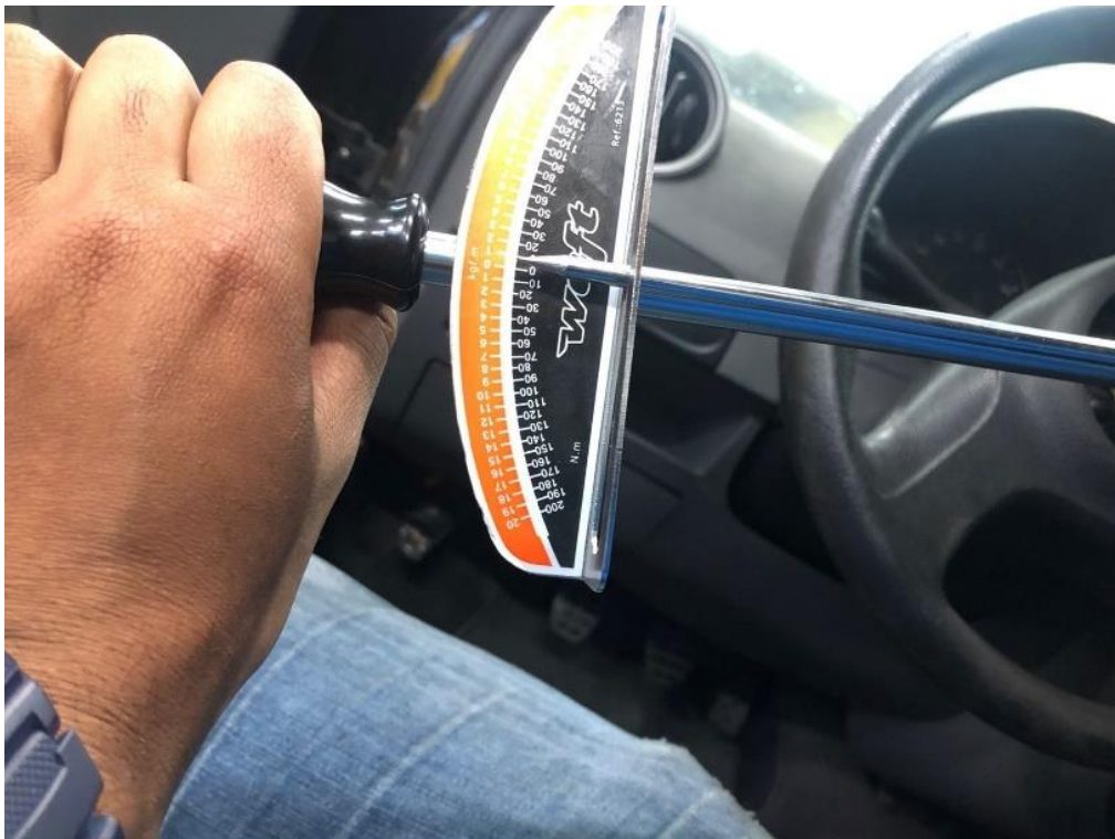
Figura 43 - Torque necessário para girar o volante
