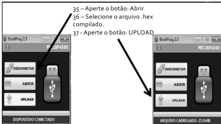
Anexo E - Figura 21 - Upload do software para a placa
