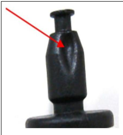
Figura 6: Peça com rechupe
