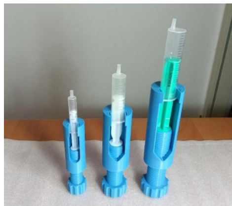
Figura 22. Controlador de gotas com arranjo feito em 3D
