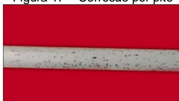
Figura 17 – Corrosão por pite
