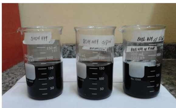
Figura 7: Chapas de alumínio mergulhadas em vinho.
