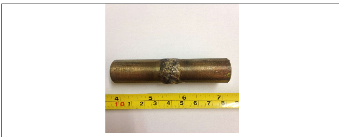
Figura 21 - Corpo de prova com processo de soldagem TIG finalizado.
