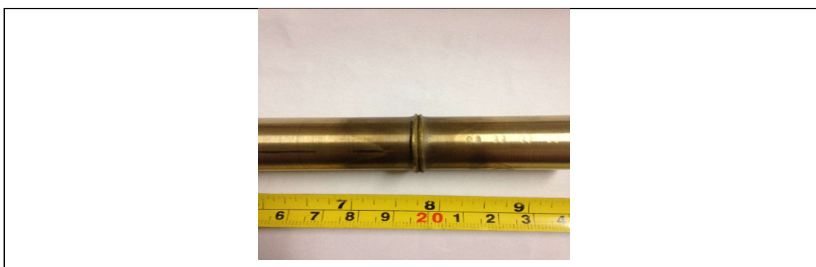
Figura 22. Corpo de prova com processo de solda por fricção finalizado.
