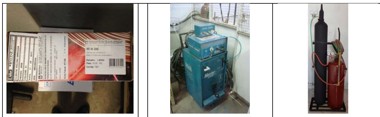
Figura 17 - Imagens do código do eletrodo, do equipamento de solda TIG e de gás oxiacetileno.
