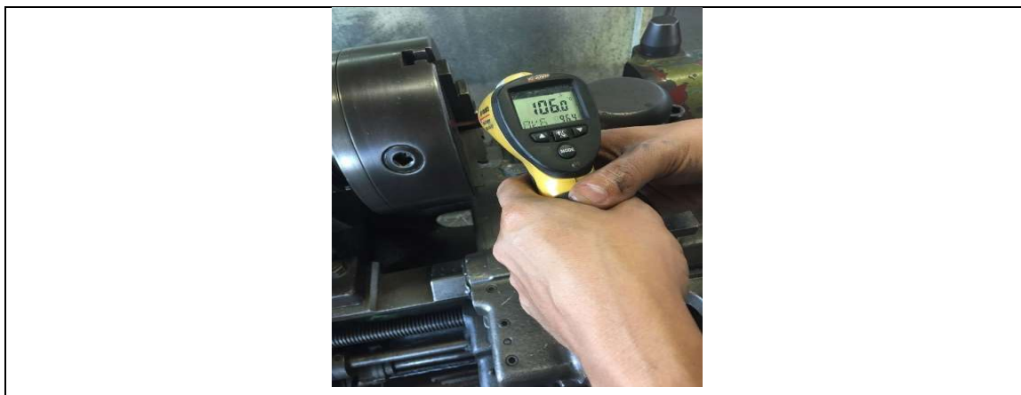
Figura 19 - Imagem da temperatura de soldagem por fricção pelo instrumento.
