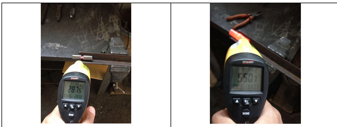
Figura 18. Imagens das temperaturas de pré-aquecimento e temperatura soldagem medidas pelo pirômetro.
