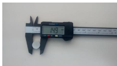
Figura 6. Corpo de prova para realização do ensaio potenciodinâmico AA5052
