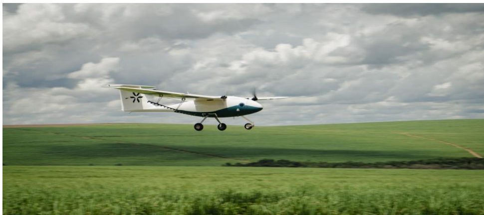
Figura 6. Drone de pulverização da empresa americana Pyca, desenvolvido para ser um complemento a aplicação aérea comum de aviões. Sua proposta é ter uma faixa de deposição de 13 metros e decolar com mais de 200 quilogramas de peso de decolagem. Fonte: Pyca, Estados Unidos, 2022.
