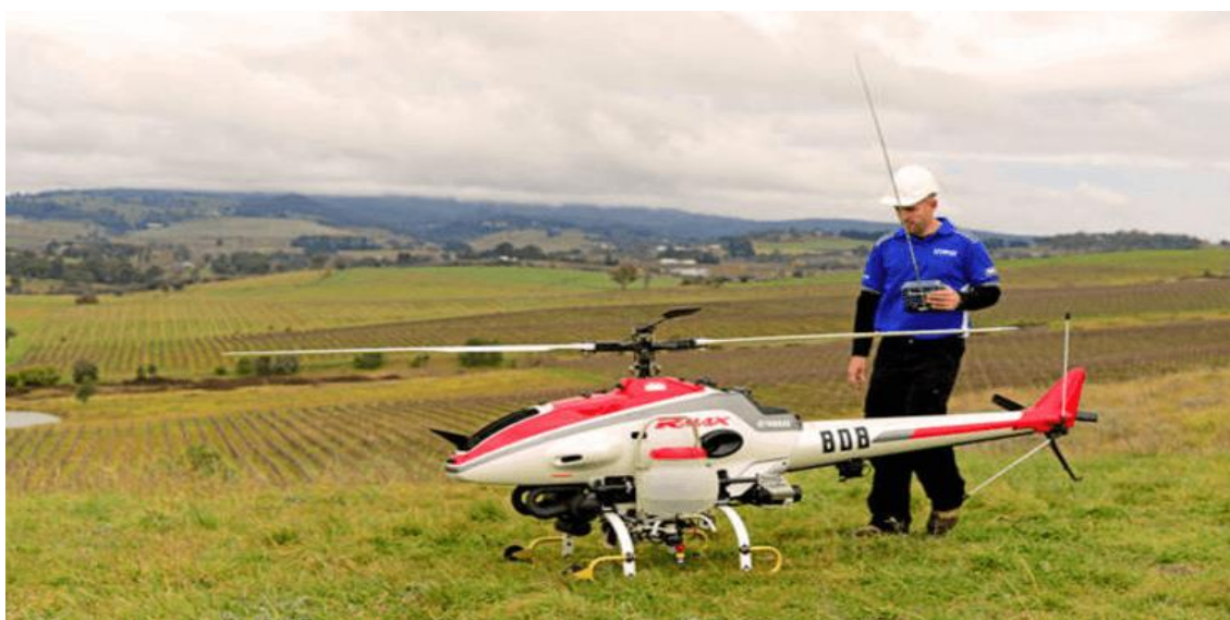
Figura 3. Helicóptero de uso remoto fabricado pela japonesa Yamaha. O modelo R-MAX tem a capacidade de pulverizar áreas de difícil acesso. A tecnologia despontou como uma forma de complementar a pulverização costal. Fonte: Farmfor, Brasil, 2016.
