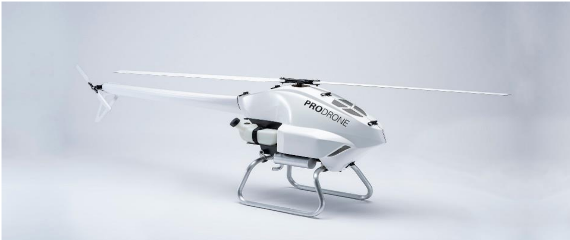
Figura 5. Drone de rotor único utilizado para fins profissionais. Modelo PDH-GS120, capaz de fazer o sensoriamento em áreas agrícolas. Fonte: AeroExpo, Brasil, 2021.
