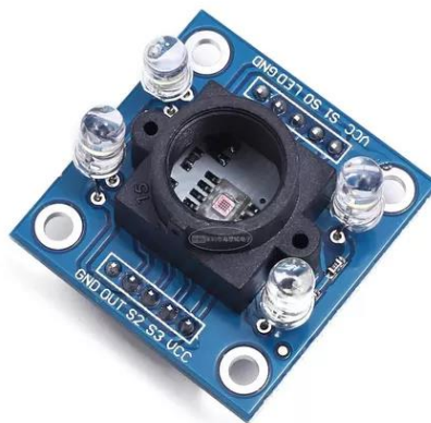
Figura 3: Sensor de Cores RGB Tcs230 Tcs3200 Arduino Gy-31
