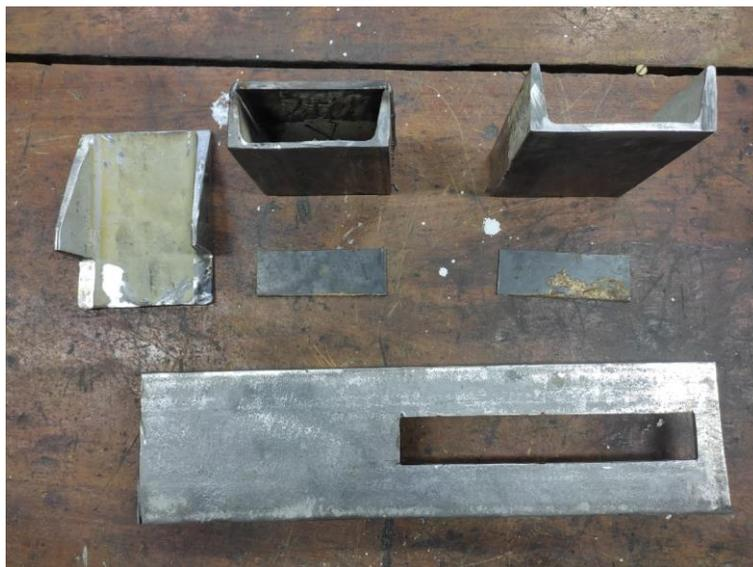
Foto 5: Corte central na Base, Tampa superior dos mordentes, base traseira da morsa.
