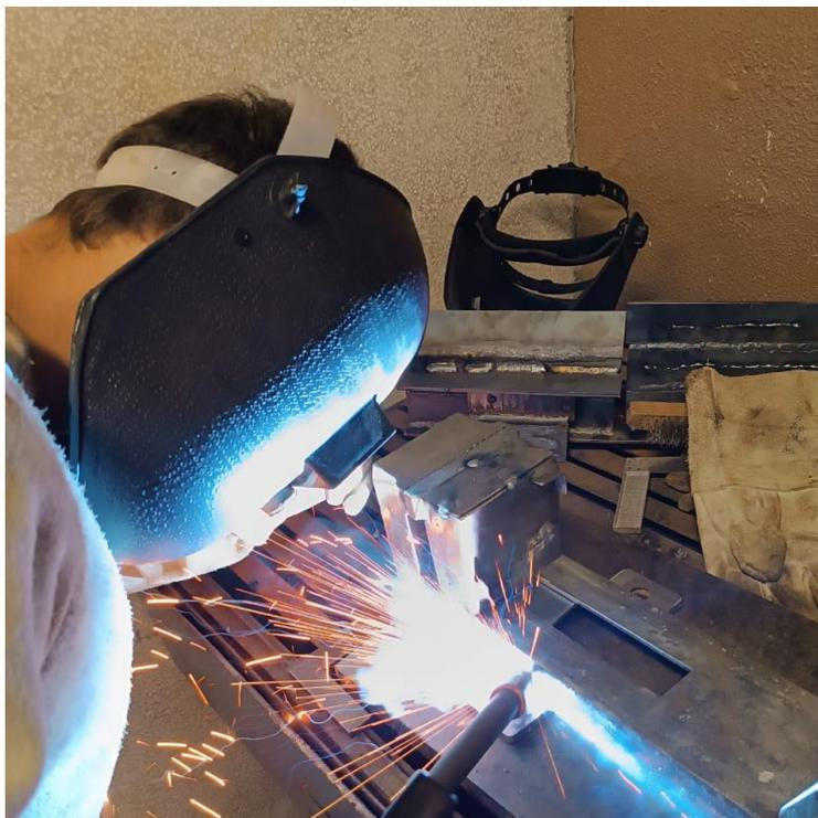
Foto 17: Soldagem das Orelhas de Fixação.
